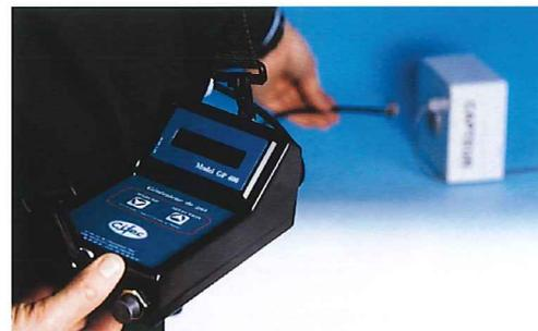
Générateur portable de gaz CIFEC GP400 pour calibrage des détecteurs
