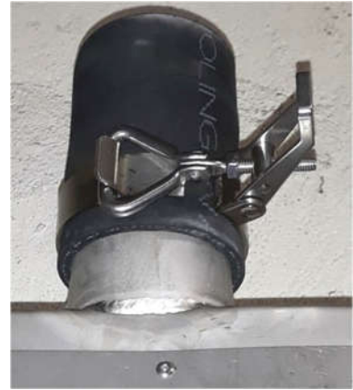
Nouveau système de fixation des plateaux
