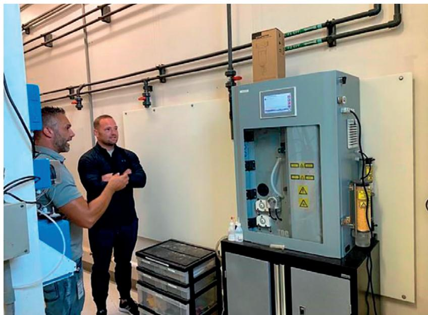
Pour le suivi de la matière organique totale, Swan propose de COT Evolution VUV, un COTmètre par oxydation développé par Seres OL (absorbée depuis par Swan) paramétrable selon l'application prévue. Ici il suit la qualité d'une eau brute en entrée d'usine de potabilisation.
