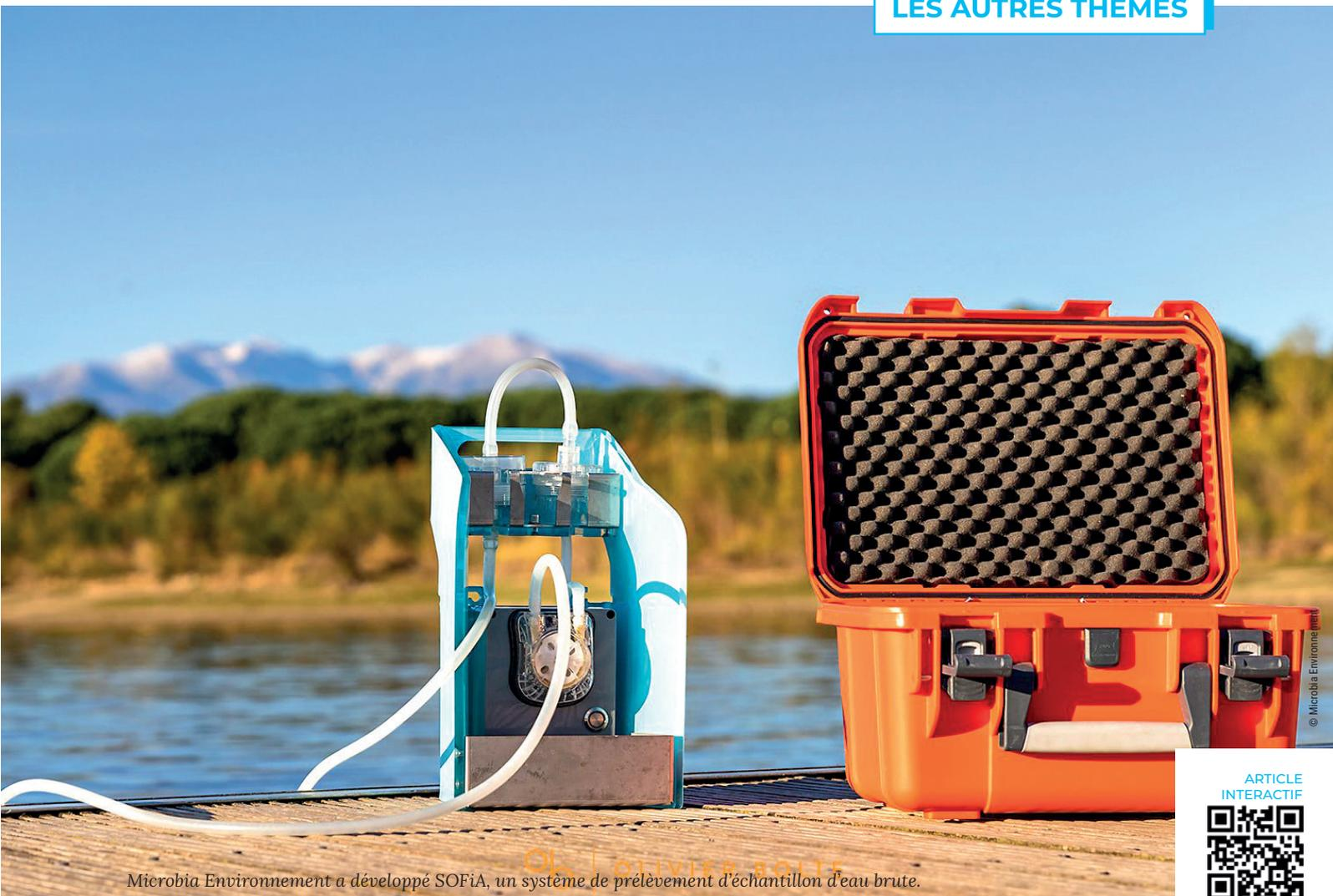
Microbia Environnement a développé SOFiA, un système de prélèvement d'échantillon d'eau brute.
